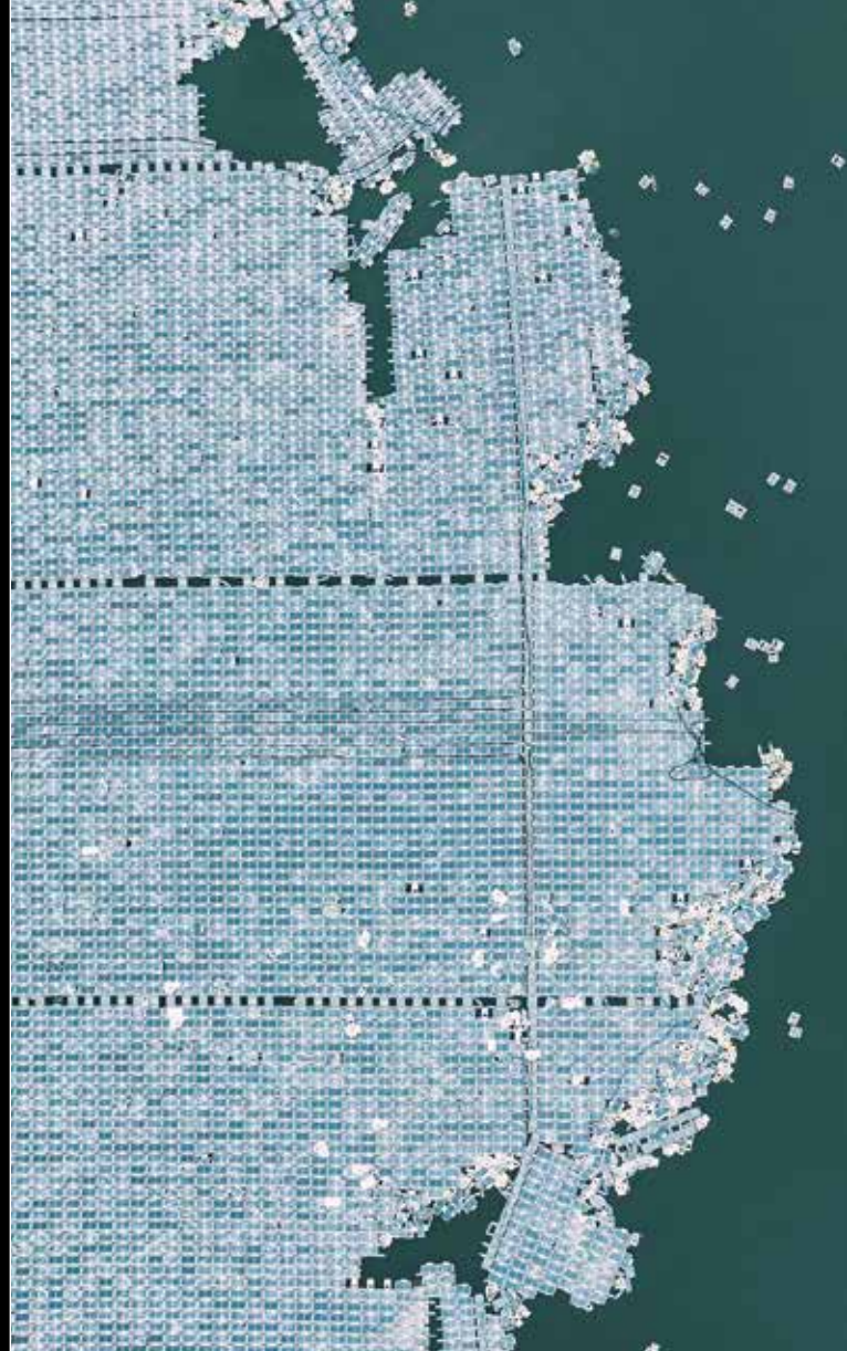
Половината, от И-Сунг Лин. Плаващи соларни панели в Тайван, наполовина унищожени от тайфун през 2025 Half, by Yi-Hsuang Lin. Floating solar panels in Taiwan, partially destroyed by a typhoon in 2025. By
